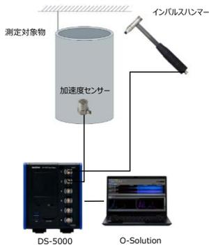
振動や異音の対策には、対象物もつ固有振動数を把握することが重要。O-Solution/DS-5000は、インパルスハンマーを用いた加振実験で素早く正確に測定することができる。
